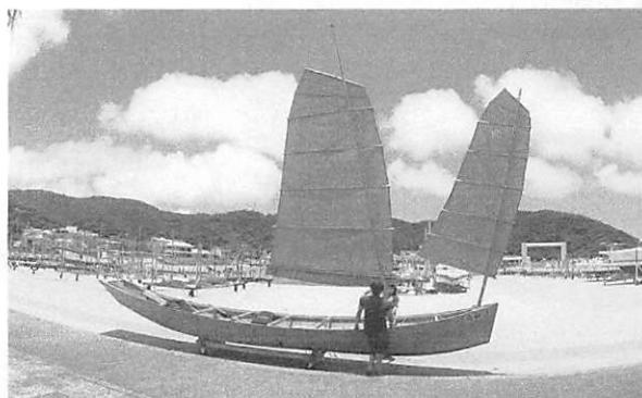
写真2 筆者の所有する木製の帆掛けサバニ(全長8.2m)
