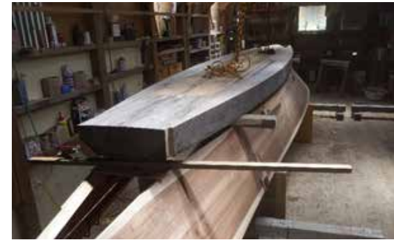
ハラケーギにスクジーを乗せ、形成していきます。継ぎ合わせ部分にはイヌマキ材で作られたフルーと呼ばれる楔が使われます。
