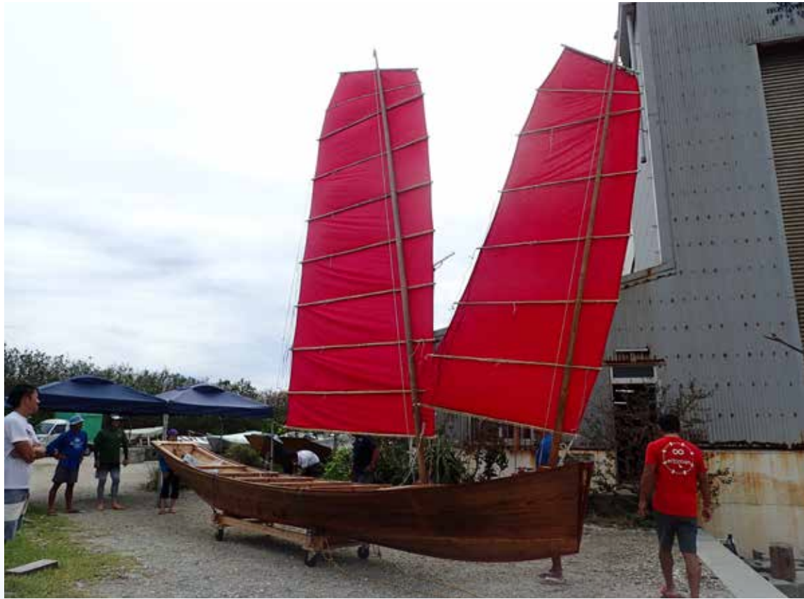
完成してサバニアギヤー(船台)の上で進水を待つ清和丸(2枚帆を備える)
