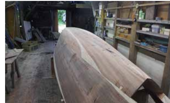
念入りにカンナで削られて、船底の丸みがつくられていき、木肌も美しさを増していきます。
