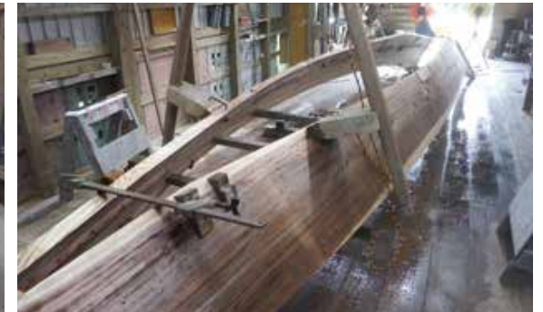
ハラケーギに圧力とお湯をかけながら、美しい曲線が作られます。
