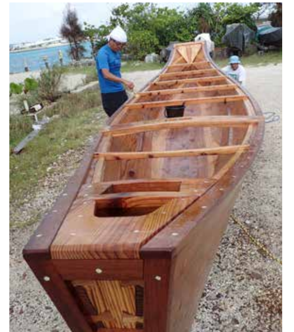
伝統を守り、船体の保護のために船体にサメの肝油(サバアンダ)を何度も塗ります。肝油の独特な香りが船に染み込んでいき、あめ色の美しい光沢を放ちます。
