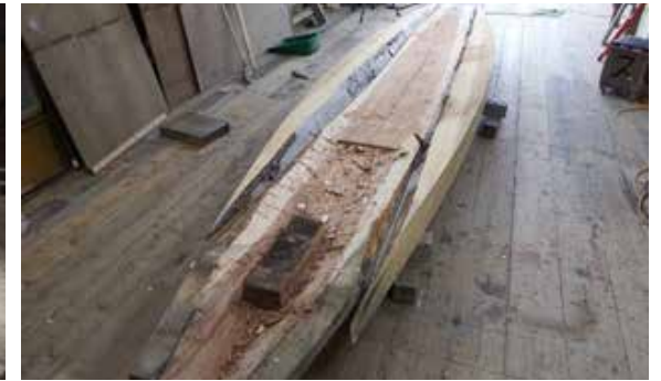
ハウシミー(帆柱を支える土台部分)を残しつつ、分厚い板を削り抜いてスクジーが作られます。手斧で粗削りしたあと、カンナで削っていきます。
