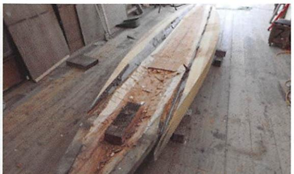
ハイウシミー(帆柱を支える土台部分)を残しつつ、分厚い板を割り抜いてスクジーが作られます。手斧で粗削りしたあと、カンナで削っていきます。
